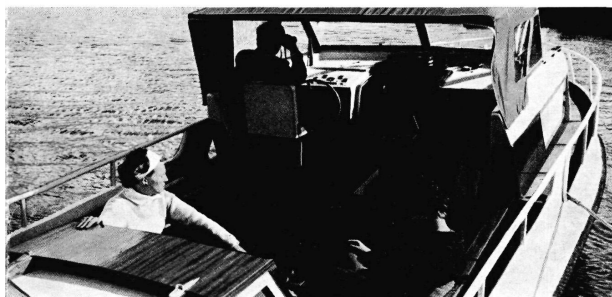
zelflozende kuip met stuurstand onder soft-top
